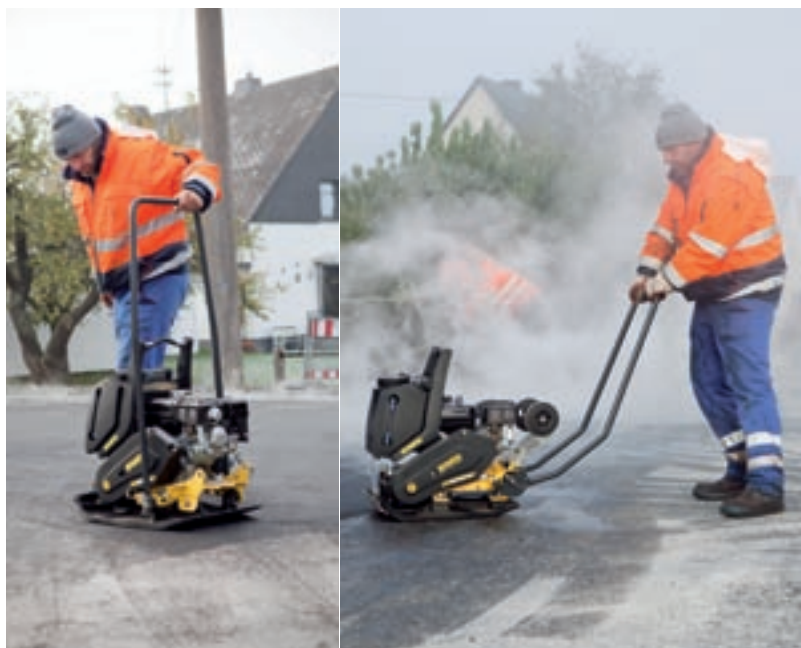
Центральная дуга (опция): Для легкости в управлении и более высокой маневренности.
