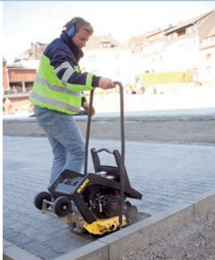
Центральная дуга (опция): Для максимальной маневренности в углах и краевых зонах.
