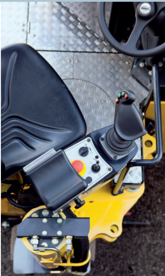
Гибкая укладка гидролиний в контуре колесной ниши.
