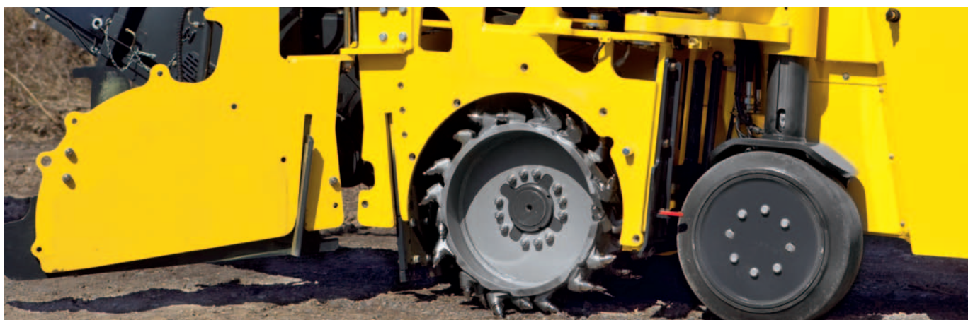
...и вот свободный доступ к фрезерному барабану.
