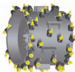
Быстросменный фрезерный барабан Ширина фрезерования: 500 мм Расстояние между линиями: 15 мм Глубина фрезерования: 0-210 мм
