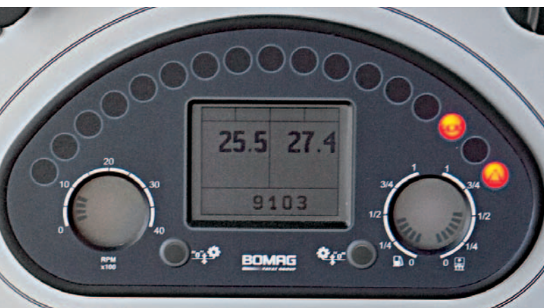
Цифровой индикатор глубины фрезерования и выключатели скоростей перемещения расположены точно в поле зрения оператора.
