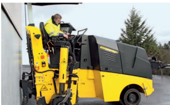
Отсутствие мешающего регулировочного цилиндра в задней части дорожной фрезы.
