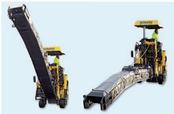
С самого верха в самый низ одним движением и без перевешивания – просто управляется с рабочего места оператора.
