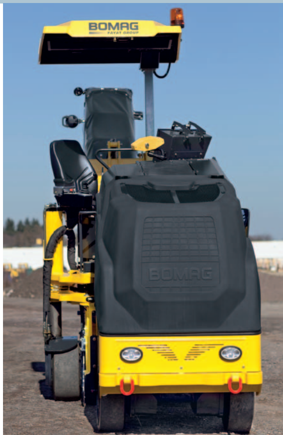
Забор воздуха осуществляется сверху, так как наиболее чистый воздух обеспечивает длительный межсервисный интервал.
