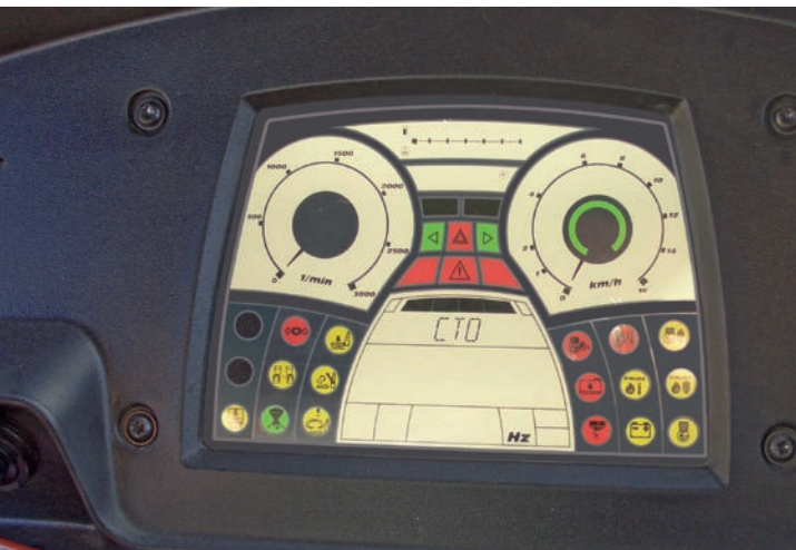
... и ЖК-дисплей для катков с системой BOMAG ASPHALT MANAGER.
