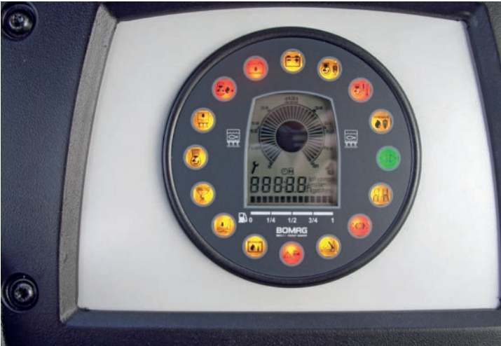
Современный дизайн консоли с цифровым экраном отображает все важные функции. Круговой дисплей для катков серии AP...
