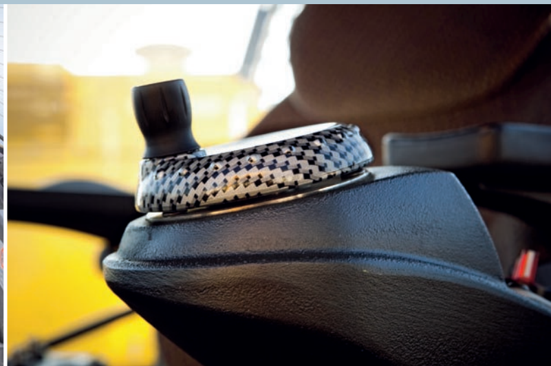
Управление кончиками пальцев: точное вращение с применением мини-рулевого колеса.
