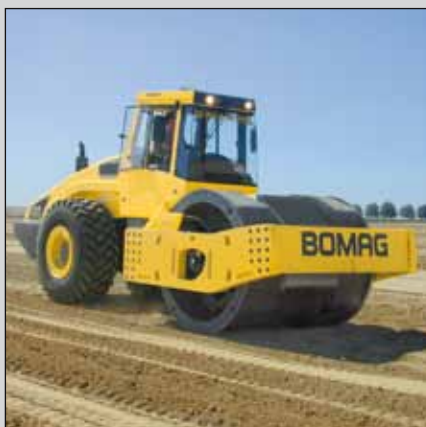
Грунтовый каток BW 226 DI-4 BVC при последующем уплотнении поверхности грунта.
