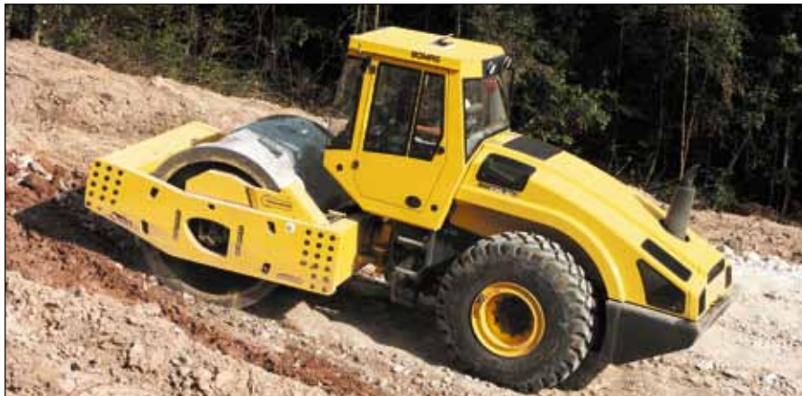
Грунтовый каток с полигональным вальцом на строительной площадке.
