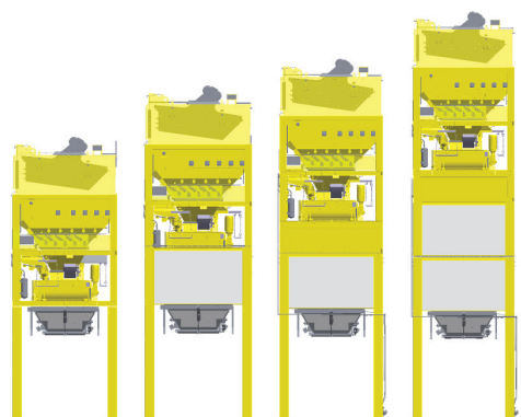
прямая разгрузка прямая разгрузка и/или 30 т бункер-накопитель прямая разгрузка и/или 2 x 30 т бункер-накопитель прямая разгрузка и/или 2 x 70 т бункер-накопитель
